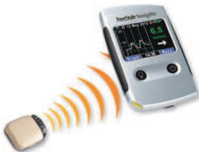
Figure 24 : Le FreeStyle Navigator II et son émetteur (Laboratoire Abbott, 2014a)
