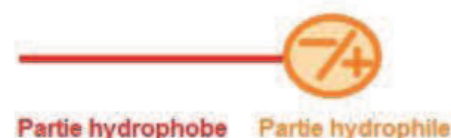
Figure 44 : Représentation schématique d'un tensioactif amphotère
