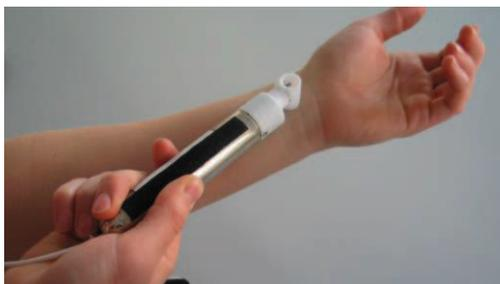
*Figure 73 : Illustration d'un Tewamètre<sup>®</sup> TM 300 et de son application à la surface de la peau*
