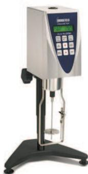
*Figure 54 : Illustration d'un viscosimètre à mobile tournant*
