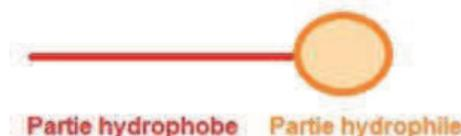
**Figure 41 : Représentation schématique d'un tensioactif**
