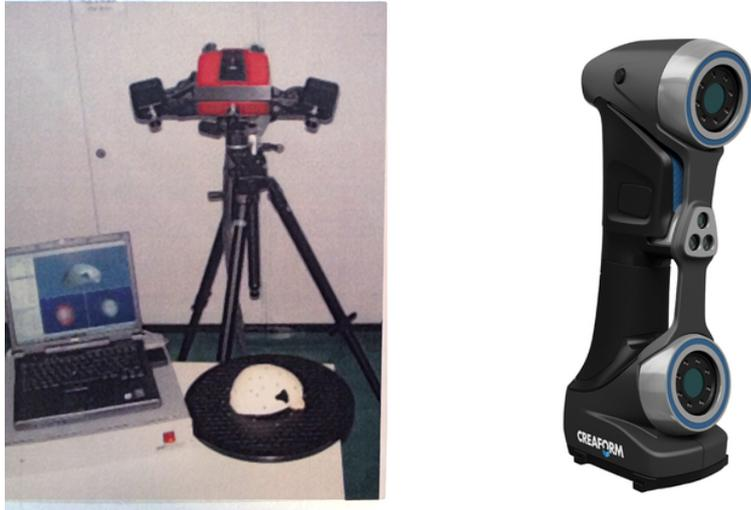
**Figure 2 : (a) scanner 3D ATOS II transportable monté sur un trépied, (b) scanner HandyScan 300 portable. Source : (a) référence (14) Thali MJ, Braun M, Dirnhofer R., (b) référence (15) [www.creaform3d.com](http://www.creaform3d.com)**
