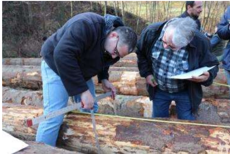
Figure 12: Mesure du diamètre d'une grume à l'aide d'un compas forestier
