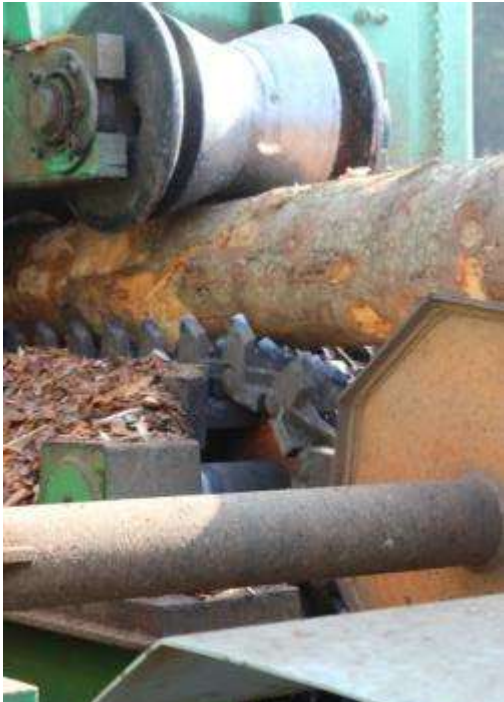
Figure 13: Passage dans le cubeur électronique d'une grume
