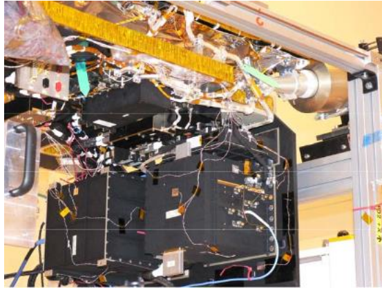
FIGURE 5 : L'UNITE DU MICRO-ONDES ALTIMETRIQUE DE L'ALTIMETRE ALTIKA (SOURCE : AVISO)
