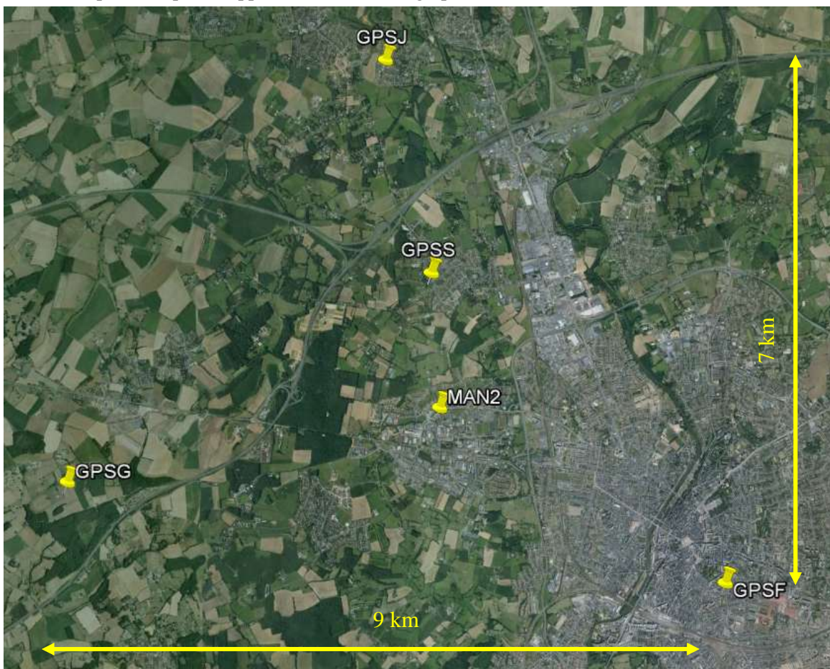
Figure 18 : carte du réseau de station GPS pour la tomographie
