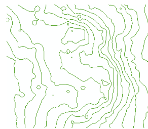
Illustration 25 - Deux monticules dans une zone de pente sur les courbes de niveau
