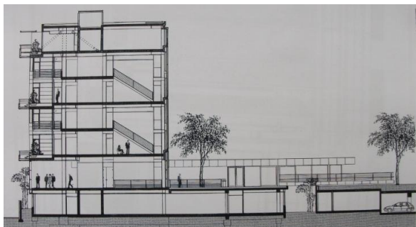
Figure 6 : Coupe transversale du bâtiment et les différences de niveaux du rez-de-chaussée (source : cabinet Dusapin)
