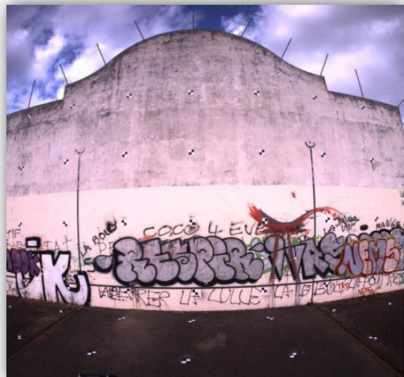
Figure 30 : Mur de calibration - image issue de la Ladybug5
