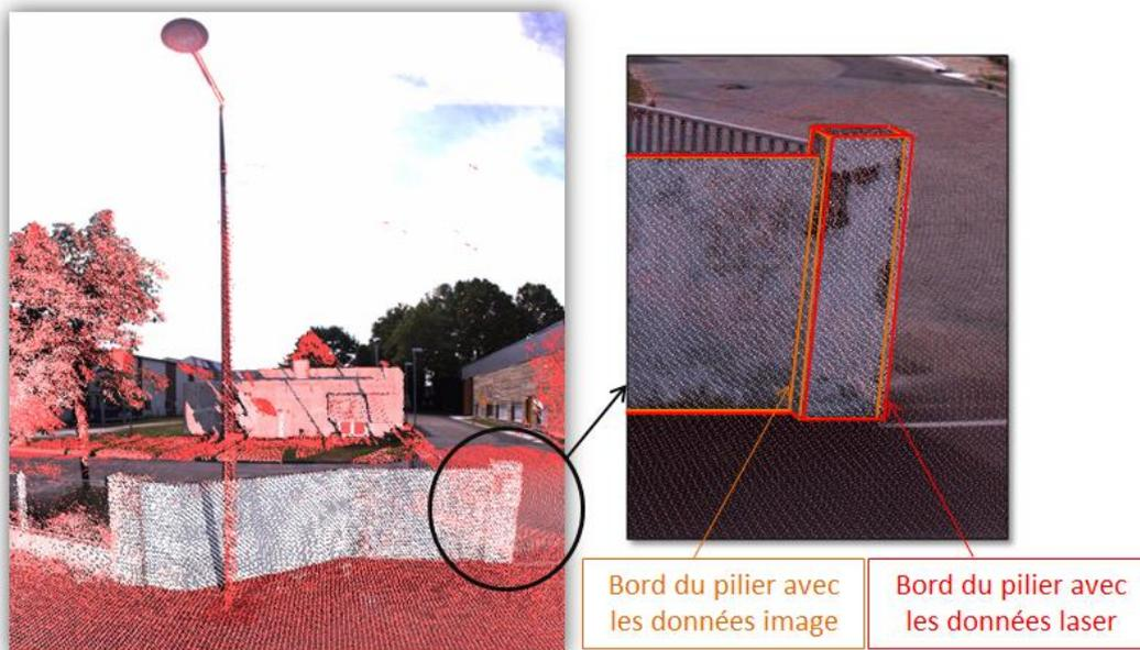
Figure 38 : Superposition et analyse de la synchronisation entre les données lasers et image
