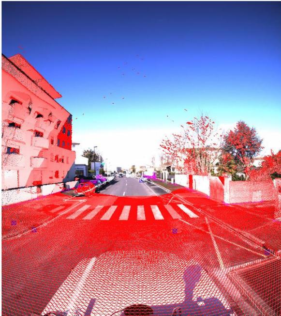
Figure 28 : Nuages de points issus des trois scanners-lasers
