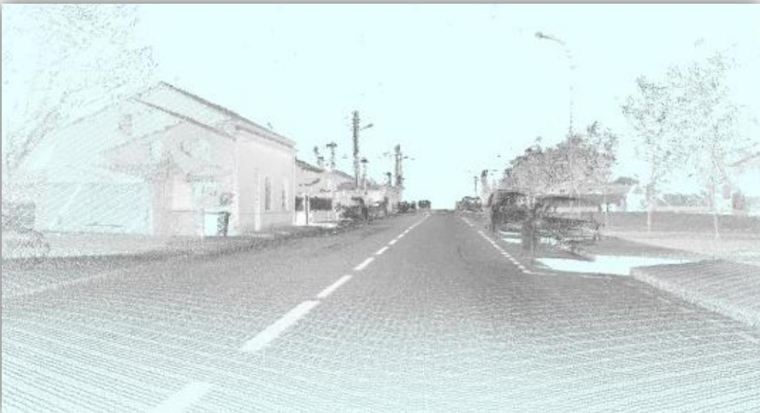
Figure 27 : Vue 3D des nuages de points pris avec les trois scanners-lasers
