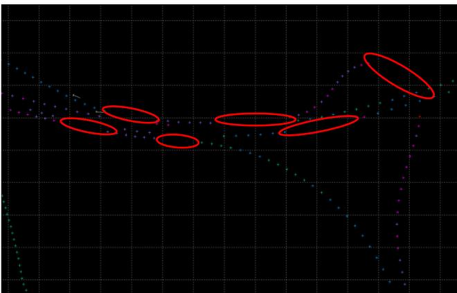
Figure 18 : Représentation de la trajectoire du mobile avec uniquement les données GNSS. Les cercles rouges représentent les coupures de signal (logiciel GrafNav)
