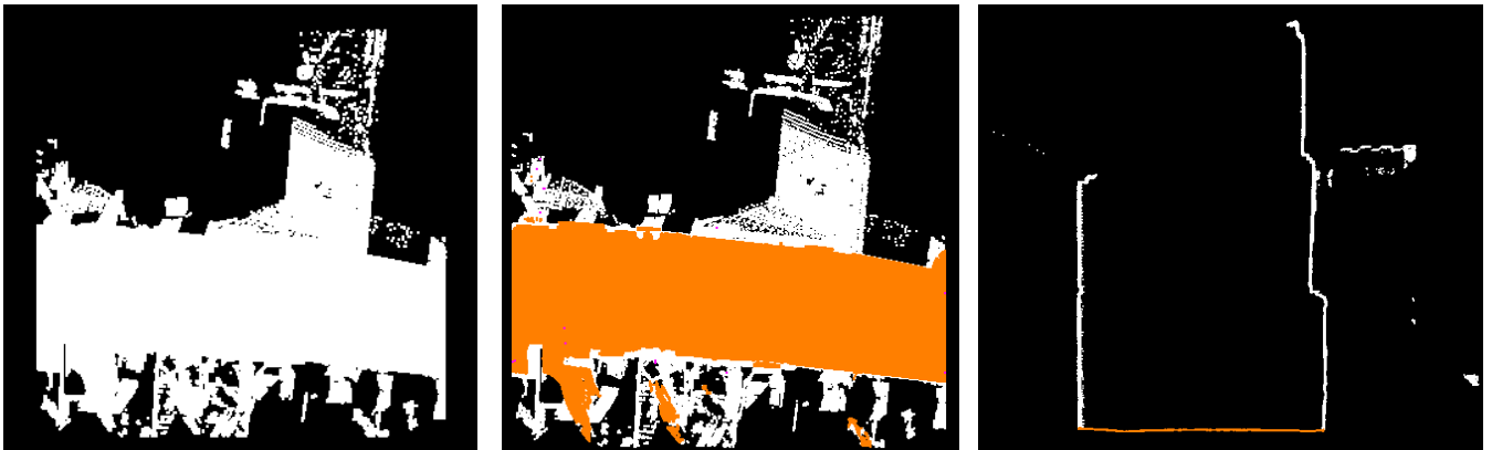
Figure 26: Nuage de points non classifié en vue de dessus (gauche). Nuage de points classifié en vue de dessus (milieu) et vue de profil (droite) avec les points appartenant à la classe sol représentés par la couleur marron. [Terrascan]
