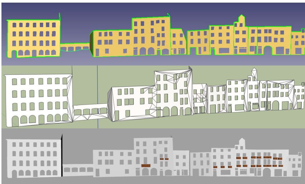
Figure 55: Modélisation obtenue sous 3DReshaper après maillage sous contrainte (haut), modélisation obtenue sous SketchUpMake (milieu) et modélisation finale obtenue sous Rhinocéros 3D (bas).
