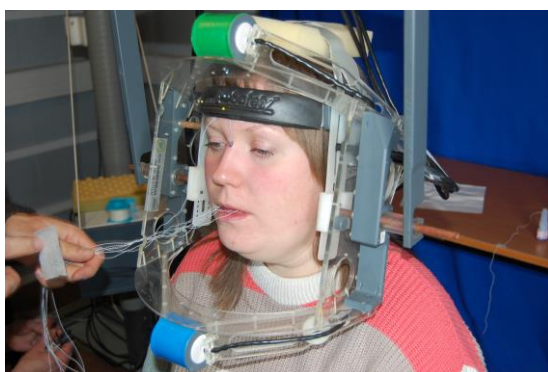
Figure 11 : Enregistrement de données à l'aide d'un EMA 2D, AG-200.
