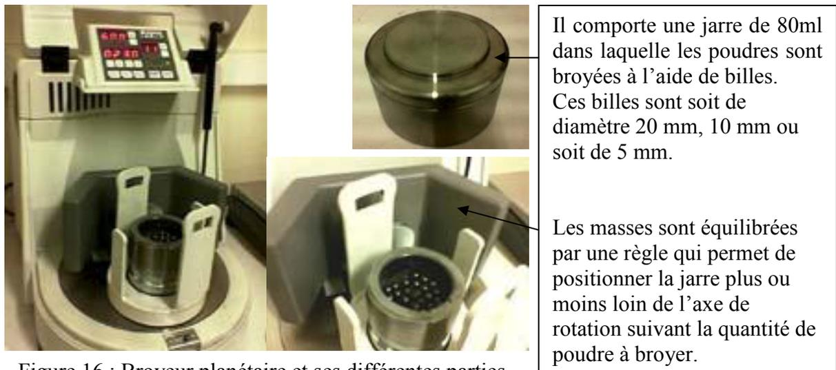
Figure 16 : Broyeur planétaire et ses différentes parties.
