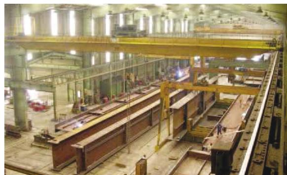
Vue de poutre de pont PRS du haut de l'atelier C
