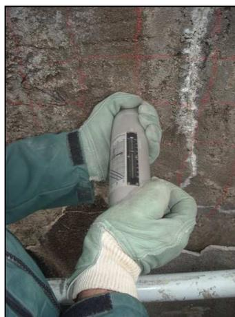
*Photo 49 - Prise de mesures sclérométriques*
