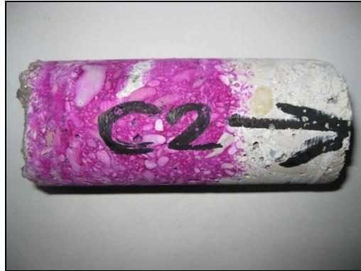
Photo 50 - Mesure de carbonatation sur un échantillon
