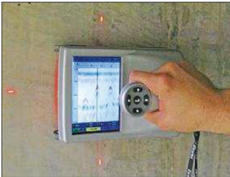
Photo 47 - Mesure d'enrobage d'armature au droit du fût
