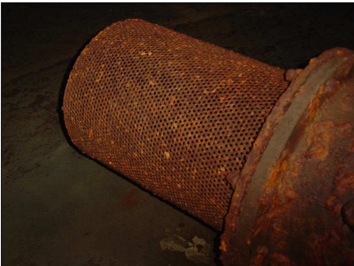
Photo 45 - Corrosion de la crépine de distribution
