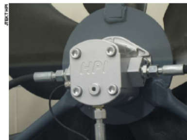
JTEKT HPI a développé la solution d'accroissement HMC constituée de capteurs reliés à une carte électronique qui transmet des informations au moteur hydraulique, permettant ainsi de réguler très précisément les besoins de retournement du moteur.
