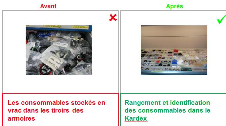
Figure 10 : Exemple d'application 5S au rangement de pièces consommable
