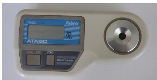
Figure : Réfractomètre pour la mesure du taux de sucre des fruits (source : Cyrielle MASSON, centre Ctifi de Balandran, 26/08/2015)
