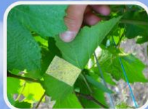
Contrôle du débit des buses et de la qualité de pulvérisation avec des papiers hydrosensibles.
