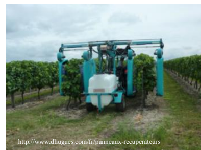
Fig. 12: Détail d'un panneau récupérateur (DHUGUES)
