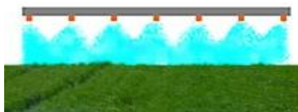
Fig. 11: Effet des buses bout de rampe (Striebel, 2015)
