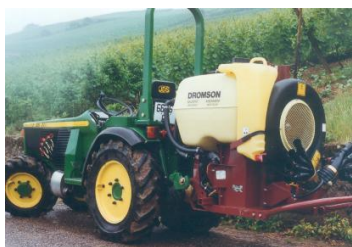
Fig. 9: Pulvérisateur porté à turbine oscillante (CARA, 2003)
