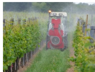
Fig. 10: Dérive lors d'un traitement avec une turbine oscillante (CARA, 2015)
