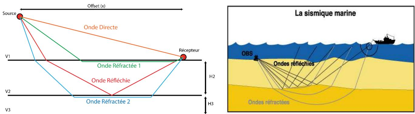
Figure 2.3 :A gauche Représentation schématique du trajet des rais sismique au travers de milieux possédants des vitesses  $V_3 > V_2 > V_1$ , entre une source (canon à air) et un récepteur (OBS). A droite : Principe de la sismique grand-angle.
