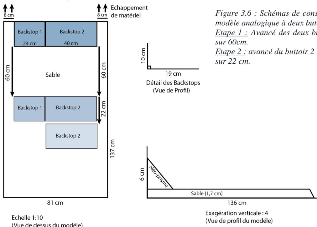
Figure 3.6 : Schémas de construction du modèle analogique à deux butées.
