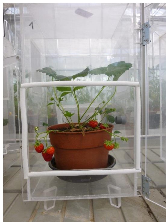
Figure 12 : Cage insect-proof utilisée pour le test de parasitisme en conditions semi-naturelles (Inra Sophia Antipolis, 18/06/2015, P. Lafargue)
