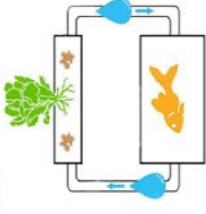
L'eau qui circule en circuit fermé est entièrement recyclée.
