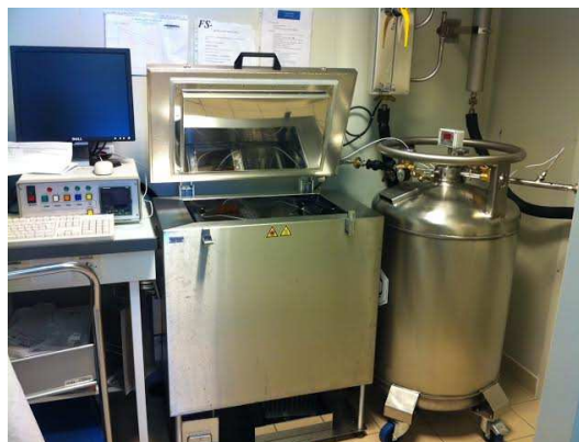
Appareil Freezal congélateur programmé pour la congélation des tissus
