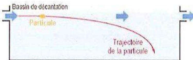
Principe d'un décanteur horizontal (Chambéry Métropole. 2015)
