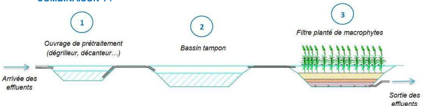
Figure 14 : coupe principe d'un système de traitement végétalisé, combinaison 1 (Valentin Roland)
