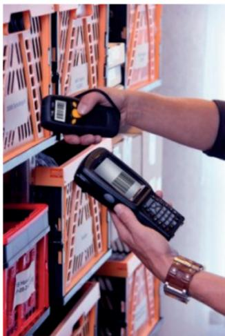
Gérez vos stocks de façon simple et performante via du matériel embarqué. PDA avec lecteur laser incorporé, sous environnement Windows. Matériel au norme IP 54 (résistance au choc, à l'humidité, à la poussière).
