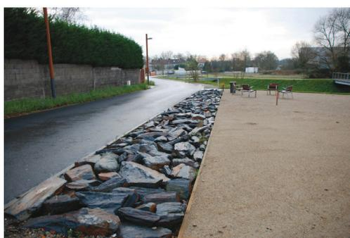
Figure 4 / Dans la ZAC du Clousis à St Jean de Monts, la Maîtrise d'ouvrage a décidé de remplacer une bande anti-stationnement végétale par une bande minérale de ce type, ceci afin de diminuer l'entretien.
