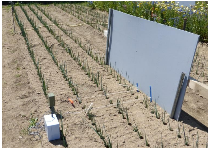
Figure 6 : Dispositif caméra BEEcam dans la parcelle de poireaux Source : T. Koch, 2015
