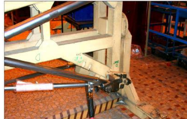
10 ème soudure : Position de départ du bâti à 180°
