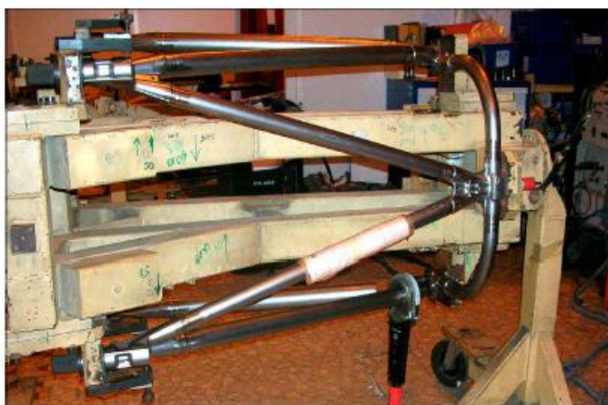
7 ème soudure : Position de départ du bâti à 90°
