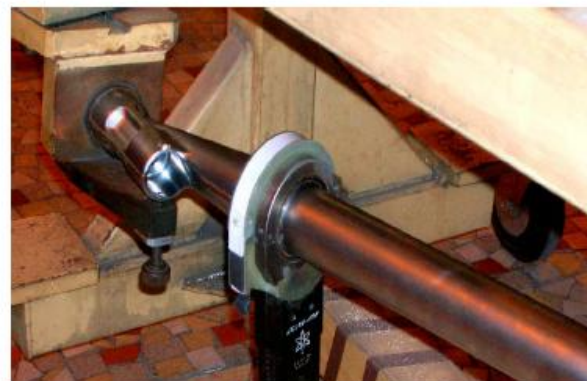
4 ème soudure : Position de départ du bâti à 90°
