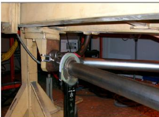
3 ème soudure : Position de départ du bâti à 90°
