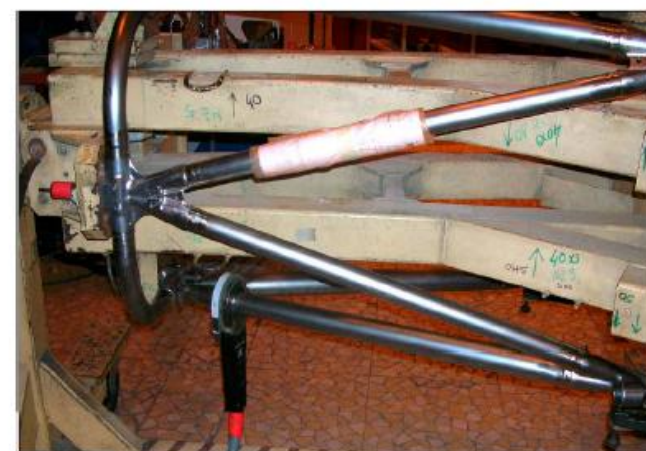
8 ème soudure : Position de départ du bâti à 90°
