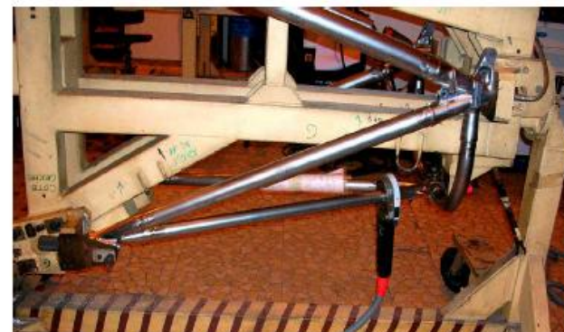
6 ème soudure : Position de départ du bâti à 180°
