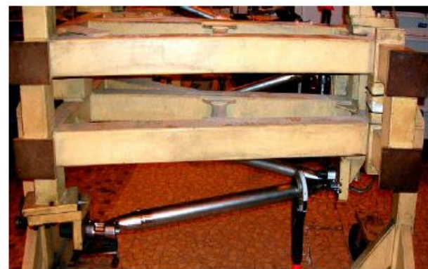
4 ème soudure : Position de départ du bâti à 90°
