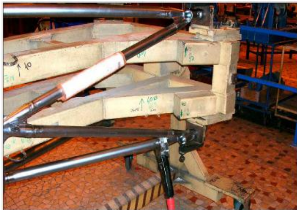
11 ème soudure : Position de départ du bâti à 90°
