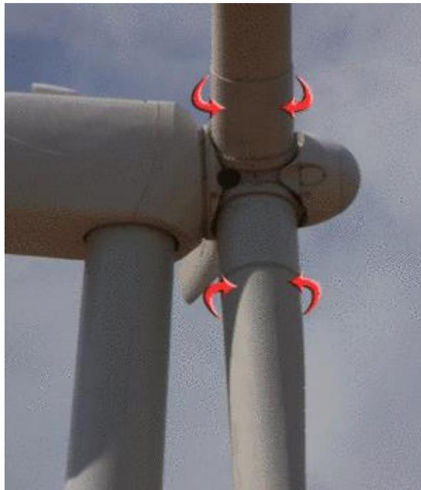
FIGURE 2-6: VARIATION DE L'ANGLE DE CALAGE DES PALES D'UNE EOLIENNE
