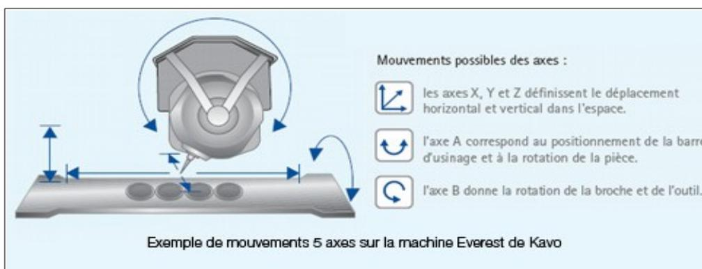
*Illustration 21: Les 5 axes des machines-outils utilisées en FAO. (61)*
