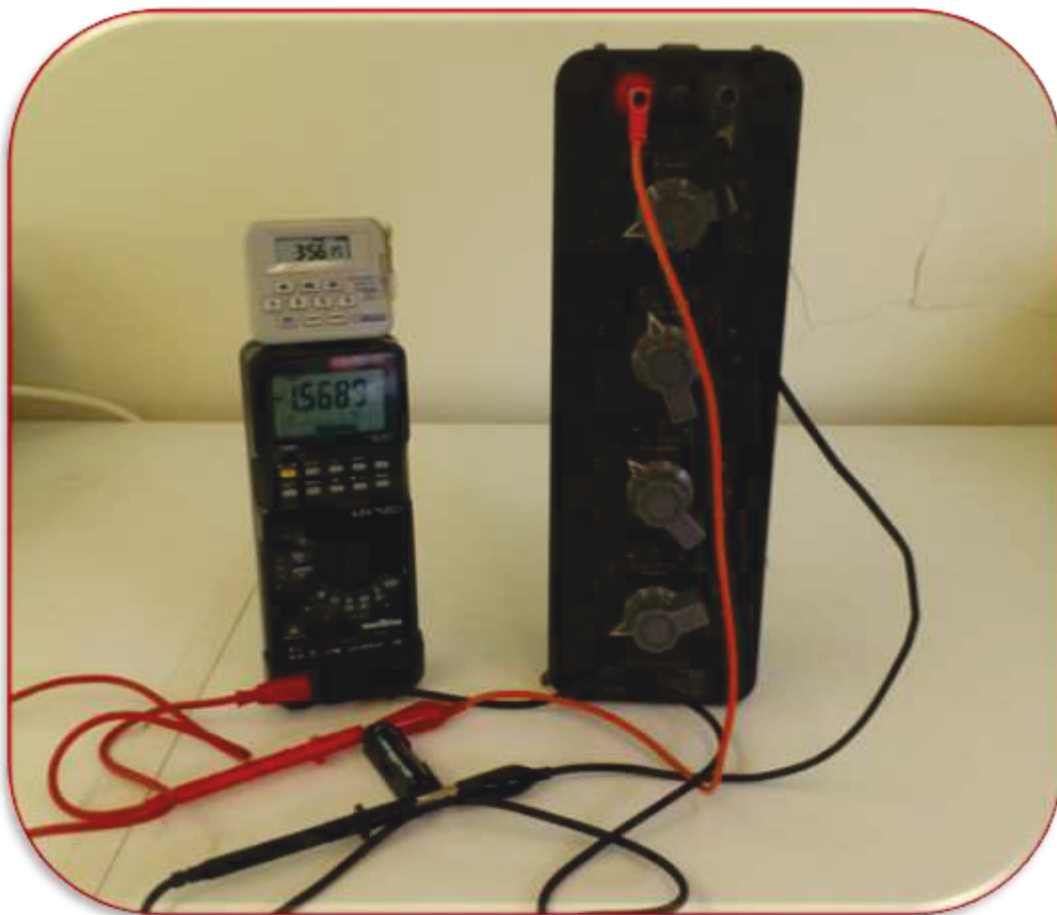
Fig. 1.4 Le test des piles électriques
