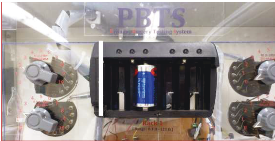
Fig. 4.11 Voie 1 avec la pile R20S
