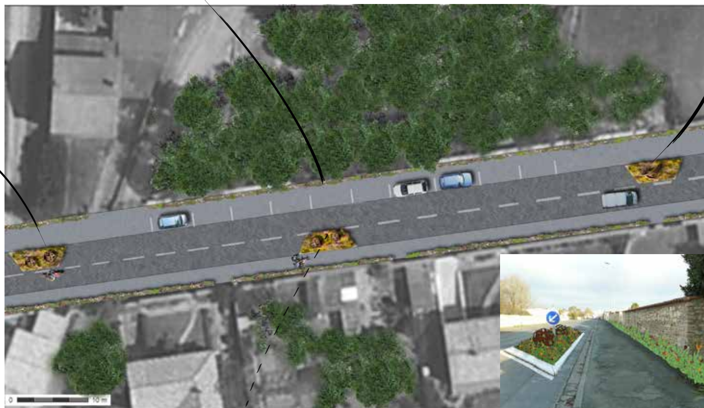
Végétalisation des îlots par des plantes grasses et vivaces de type toiture végétalisée
