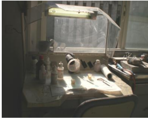
Photo 35 : Poste de travail dédié à la préparation des résines. Ce poste est équipé d'un système d'aspiration à la source
