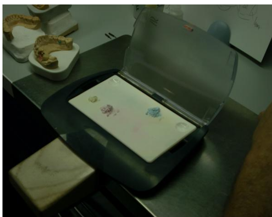
Photos 37 et 38 : palette avec les céramiques d'intérêt sous forme de poudre, puis sous forme liquide. Ajout de glycérine pour ralentir le durcissement des céramiques.
