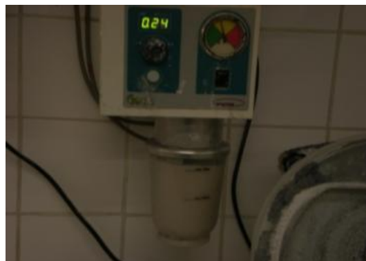
Photo 6 : Mélange du matériau réfractaire sous vide pour éviter la formation de bulles
