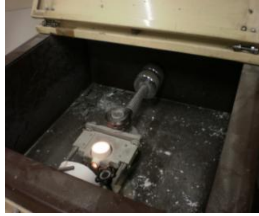
Photos 16 et 17 : Fonte de l'alliage métallique par induction électromagnétique dans une fronde centrifuge
