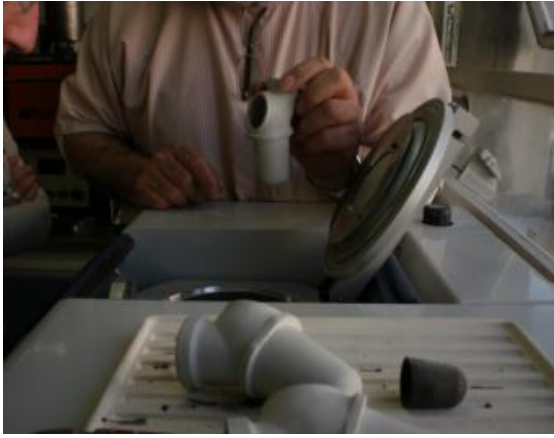
Photos 16 et 17 : Fonte de l'alliage métallique par induction électromagnétique dans une fronde centrifuge
