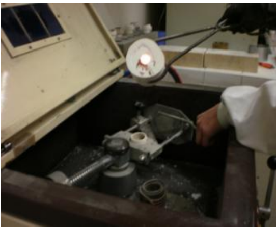
Photos 18 et 19 : Coulée de métal dans le cylindre en revêtement par la force centrifuge et refroidissement du cylindre
