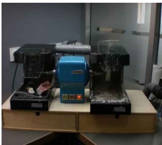
Photos 29, 30 et 31 : Polissage des prothèses métalliques avec polisseuse à tour rotative
