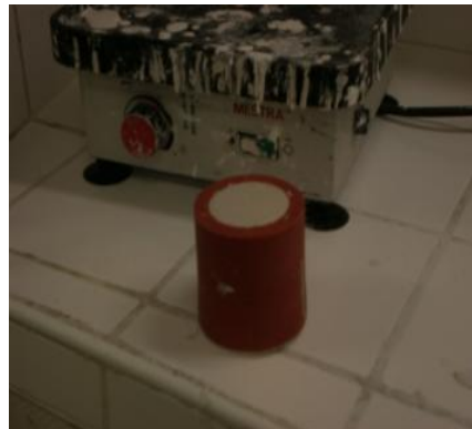
Photos 11, 12 et 13 : Etapes de la fabrication du cylindre en revêtement et temps de prise
