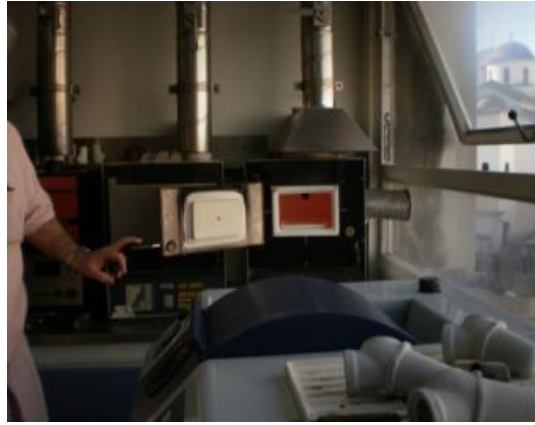
Photo 14 : Passage au four du cylindre en revêtement contenant le modèle en cire
