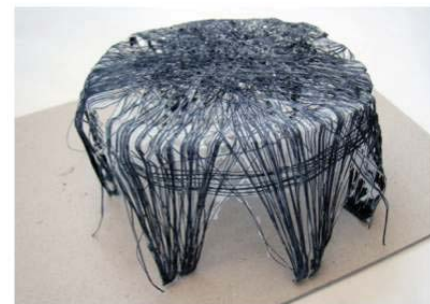
Principe d'entremellement de fils encollés pour créer un volume rigide.
