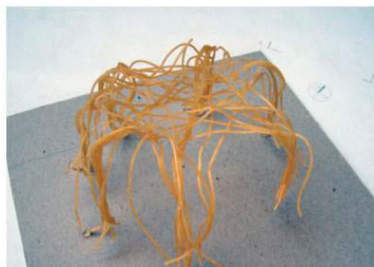
Principe d'entremêlement et d'anarchie apparente pour former un tout solide. (maquette en spaghetti)
