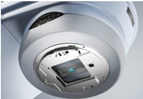
Figure 2b : Exemple de collimateur multi-lames (Varian), constitué de lames opposées. Chaque lame a un mouvement autonome piloté informatiquement afin de permettre une meilleure conformation du volume cible.
