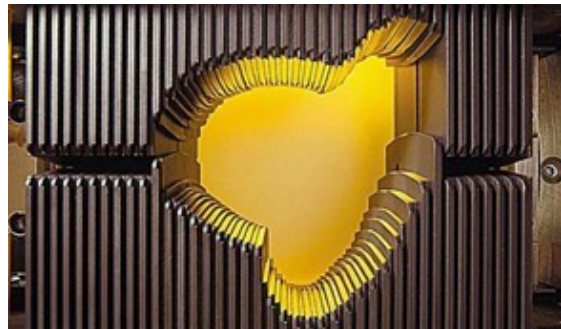
Figure 2b : Exemple de collimateur multi-lames (Varian), constitué de lames opposées. Chaque lame a un mouvement autonome piloté informatiquement afin de permettre une meilleure conformation du volume cible.
