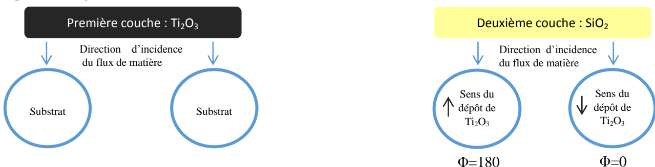
Figure 32 : les deux géométries utilisées pour l'élaboration des bicouches
