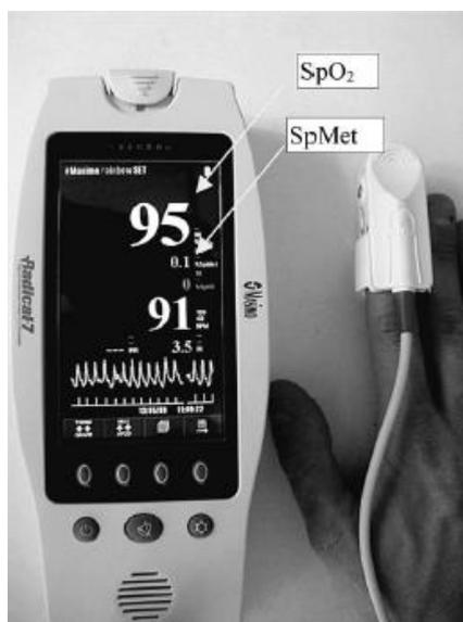
Figure 10 : Oxymètre de pouls [61]
