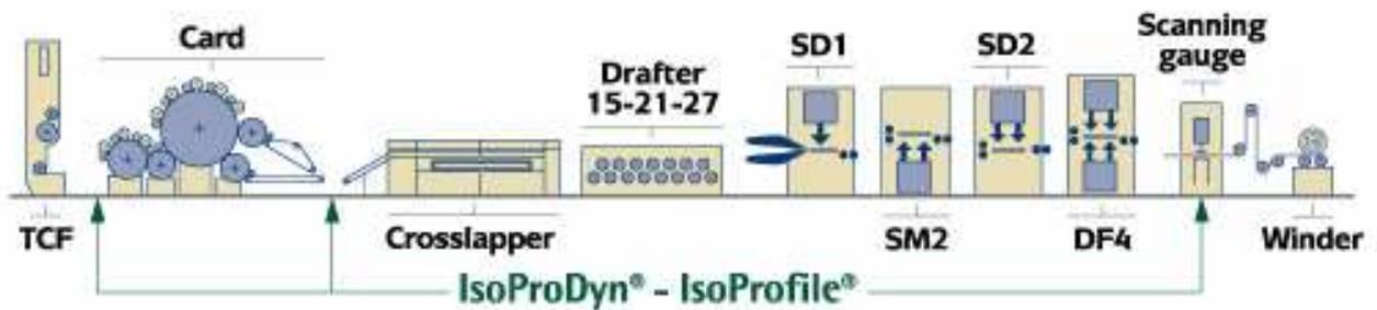
Figure 3 : Exemple de ligne de production de non-tissé
