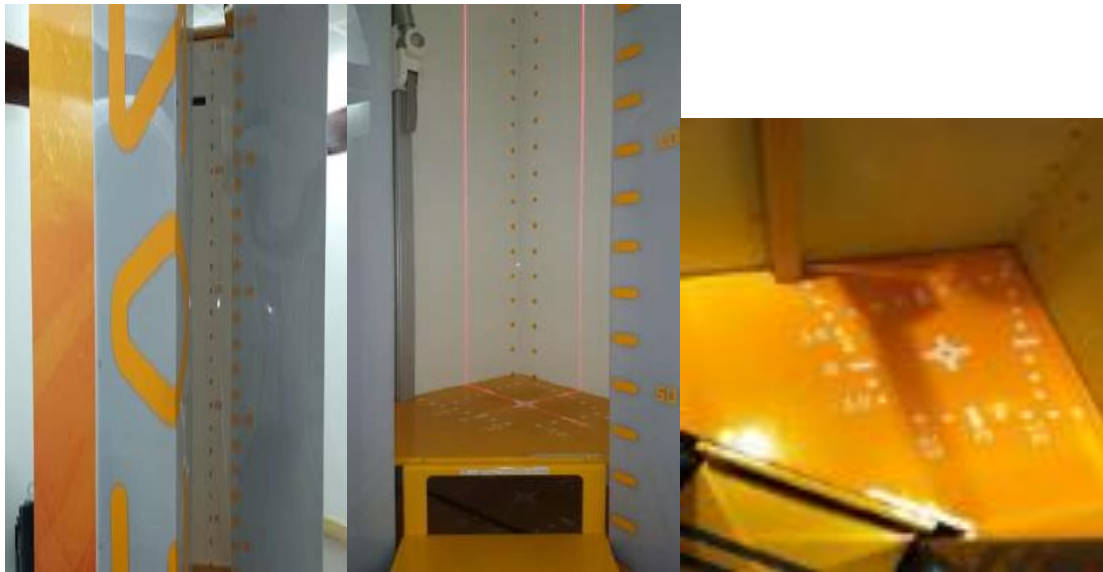
Figure 28: Cabine EOS à l'hôpital Cochin. A noter les faisceaux lasers pour définir les limites de l'acquisition et les marquages au sol pour aider au positionnement du patient dans la cabine.
