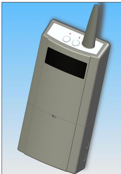
Figure 34 : Vue 3D d’un TR351, avec l’afficheur en façade et les 2 boutons et DEL
