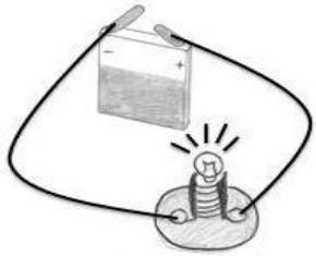
Circuit fermé : Le courant passe, la lampe brille.
