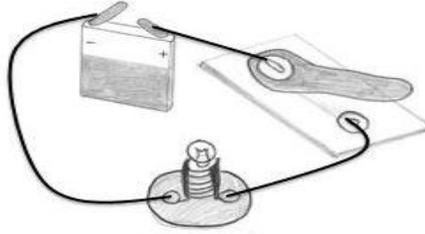
L'interrupteur ouvre le circuit, donc le courant ne circule plus. La lampe ne brille plus.
