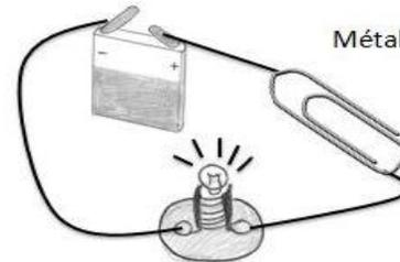
**Conducteurs** : Les matériaux conducteurs Laissent passer le courant électrique. La lampe brille.
