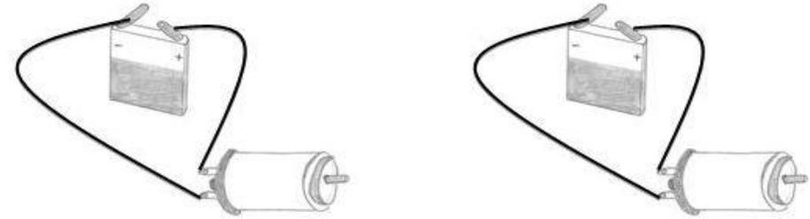
On peut réaliser un circuit électrique en remplaçant une lampe par un **moteur électrique**.
