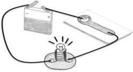
L'interrupteur ferme le circuit donc le courant circule. La lampe s'allume.
