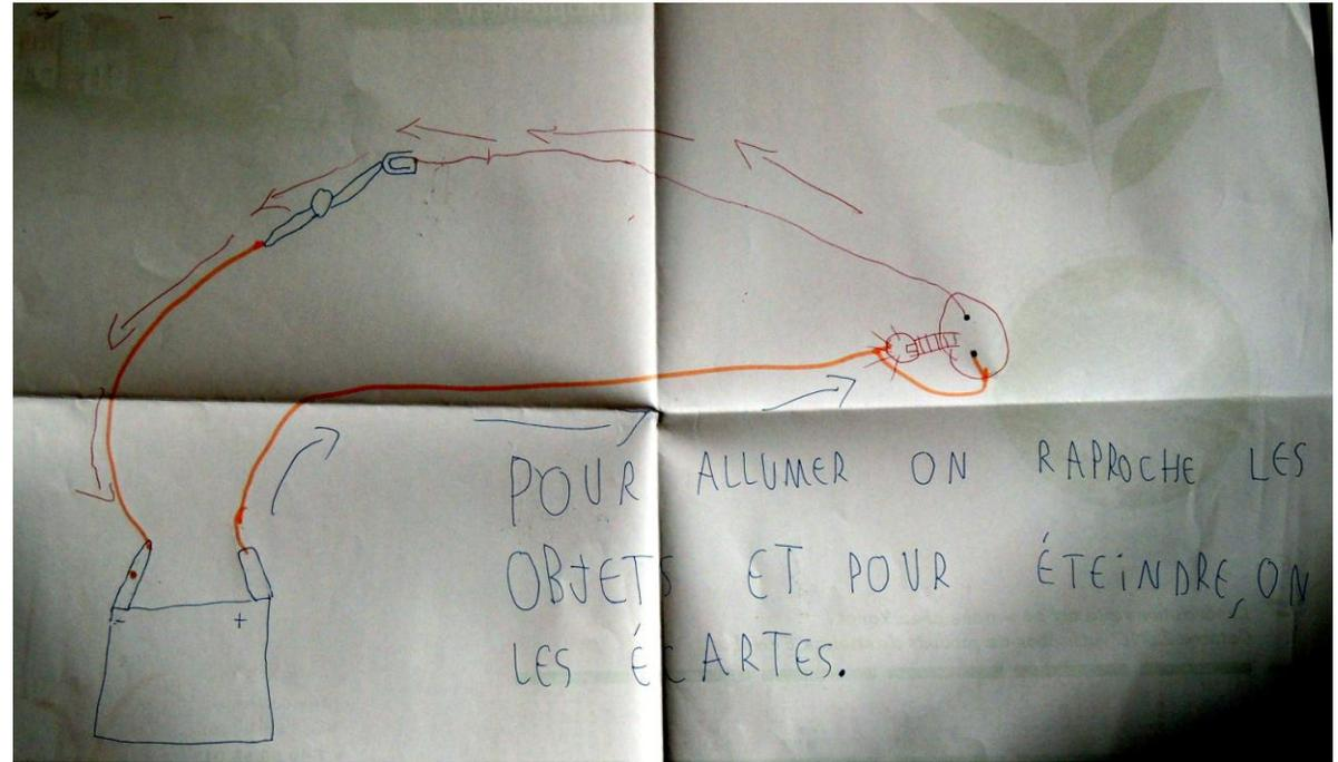
Le circuit est fermé par un trombone, quand on l'enlève, la lampe ne brille plus.
