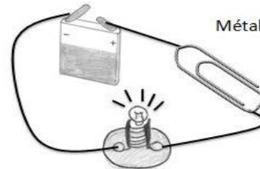
Conducteurs : Les matériaux conducteurs Laissent passer le courant électrique. La lampe brille.
