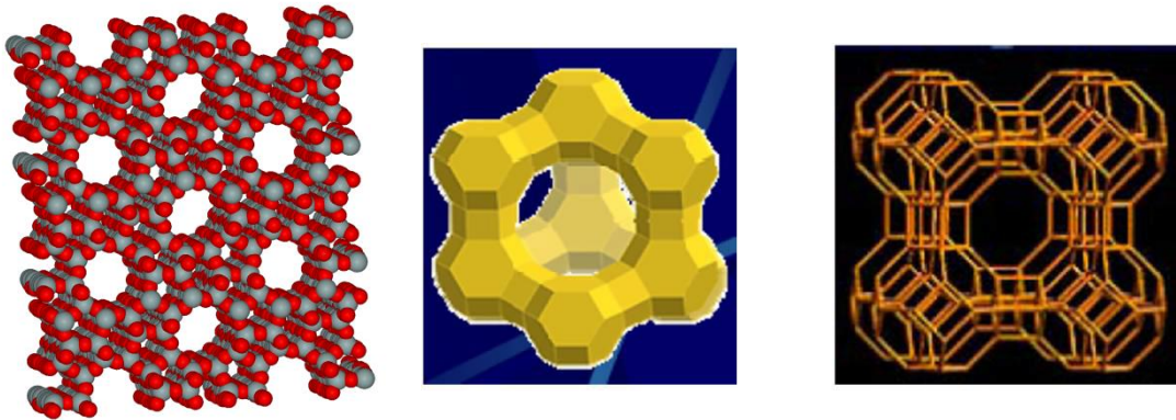
Figure 44 : Représentation schématique de la structure d'une zéolithe de type aluminosilicate [DUQ] [FIA]
