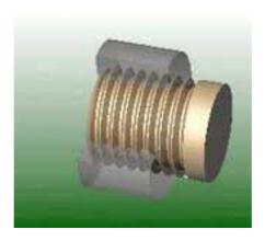
Figure 38 : Système Vis + écrou
