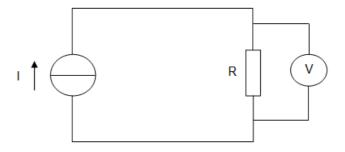
Figure 45: Schéma électrique de la mesure de tension
