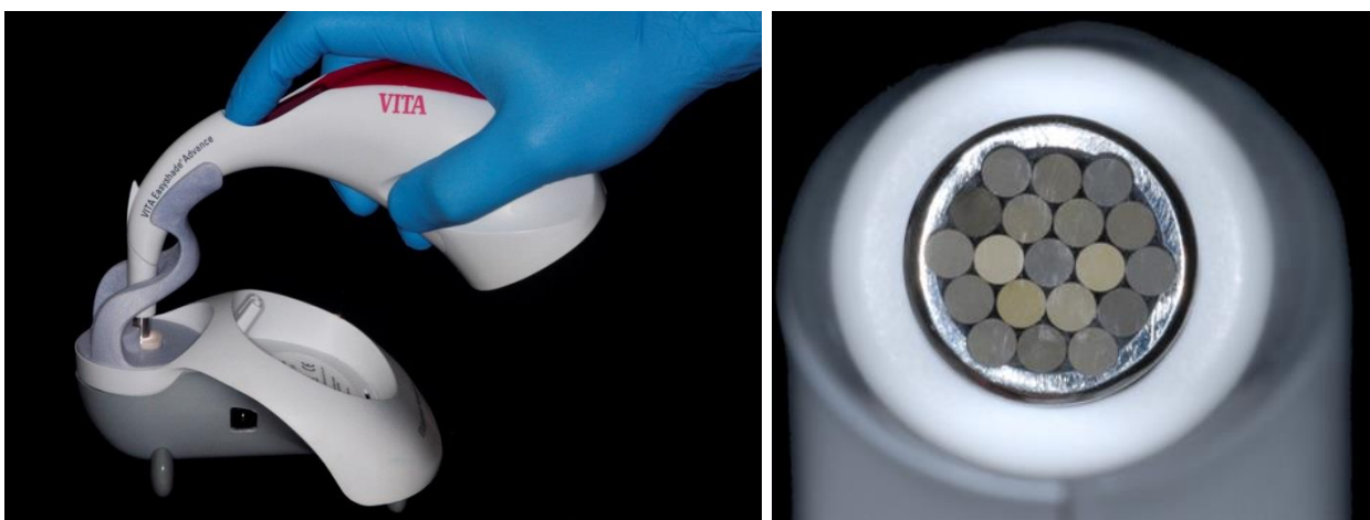
Figure 12 : étalonnage du VITA Easyshade® à gauche et capteur à droite
