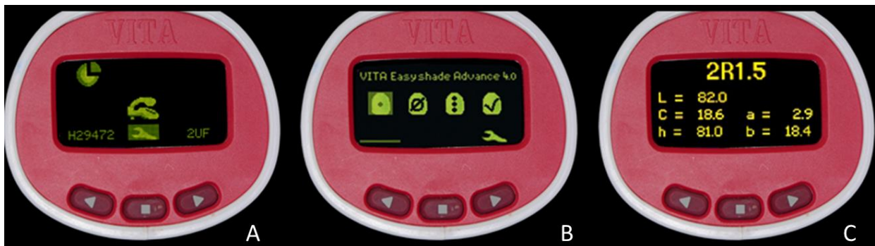
Figure 13 : (A) étalonnage de l'appareil, (B) relevé de couleur en mode "mesure ponctuelle" (1er dessin sur l'écran) ou mode "mesure 3 zones" (3ème dessin sur l'écran), (C) résultat d'une mesure exprimée dans le système CIE L*, a*, b*, C, h° et la teinte 3D Master associée
