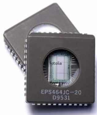
FigureI.5: Puce de silicium intégrée dans son boîtier (source fotolia)
