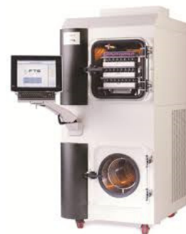
Figure N°53 : Technologie ControlLyo™ brevetée par Praxair, d'après le site SP Scientific
