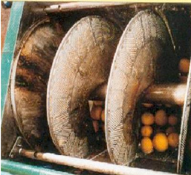
Figure 1 : presse hydraulique pour la méthode d'expression à froid
