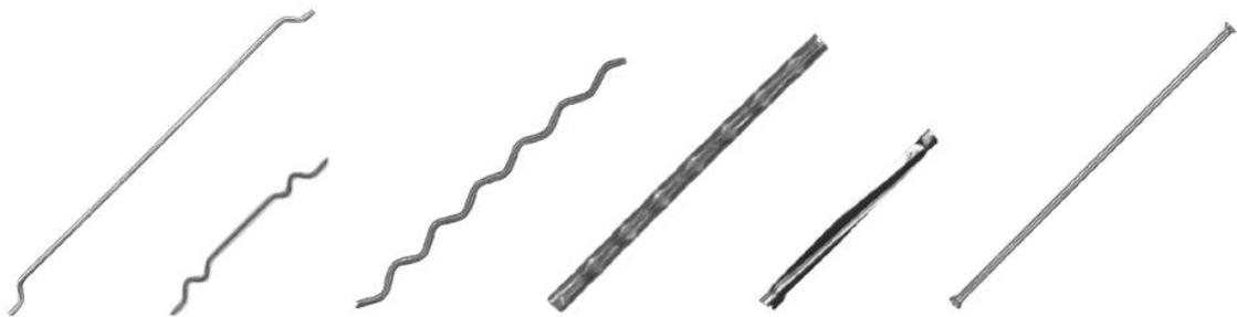
*Figure 5 : Types de fibres couramment employés dans les bétons de fibres [45].*
