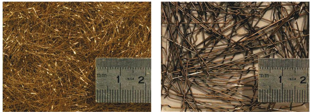
*Figure 6 : Comparaison du volume de fibres dans un BFUP (3%), à gauche et dans un béton fibré (0,5%), à droite [38].*
